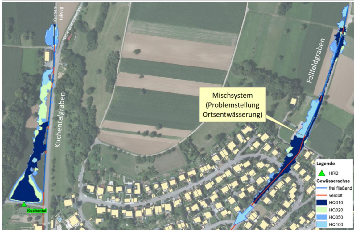
Abbildung 5.4: Teilbereich Kuchental-, Fallfeldgraben – Überflutungskarte (10a,20a,50a,100a, 100aKlima) für den Ist-Zustand
