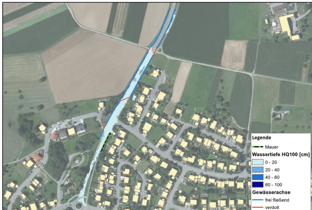
Abbildung 5.3: Teilbereich Heidelsterbach – Wassertiefenkarte (100a) für den Ist-Zustand
