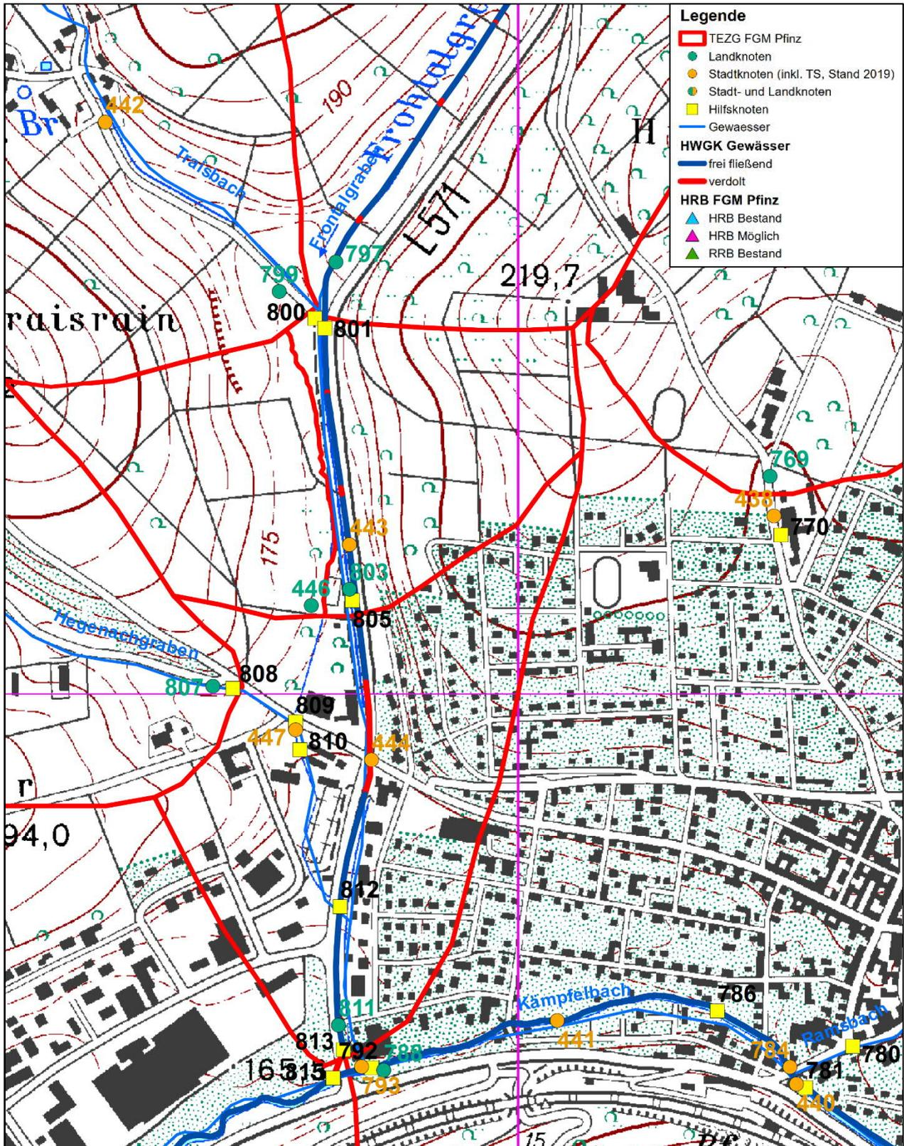
Abbildung 4.12: Lageplan ausgewählter Gewässerstellen zur Darstellung der  $HQ_T$ -Werte (Frontalgraben)
