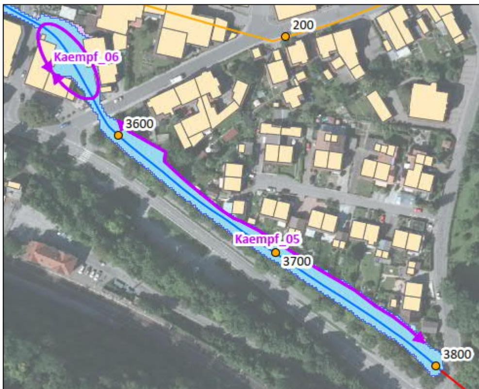
**Abbildung 7.4:** Lageplan Kaempf\_05 (Verwallung/Mauer) und Kaempf\_06 (Objektschutz)
