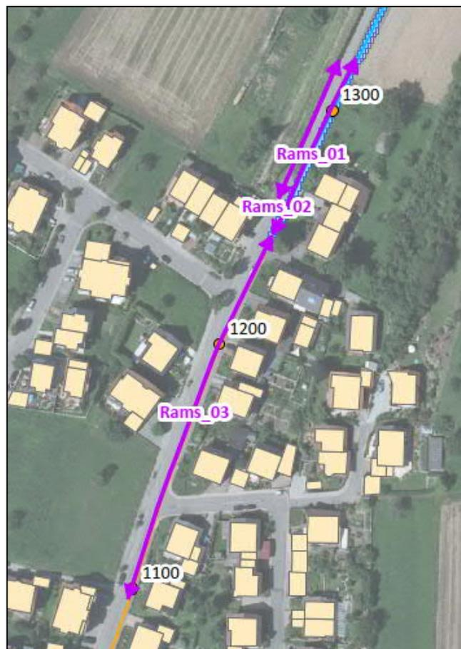
**Abbildung 7.7:** Lageplan Rams\_01 (Leichte Gewässeraufweitung), Rams\_02 (Umbau Straße) und Rams\_03 (Teilaustausch Verdolung)
